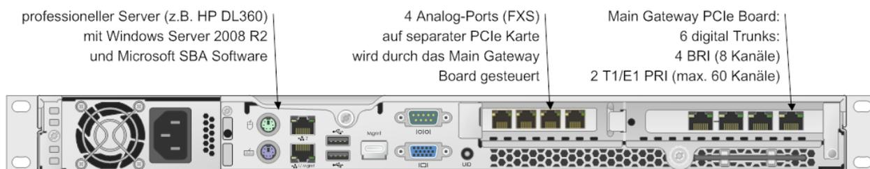
Abbildung 2.3: Anschlüsse der OfficeMaster SBA
